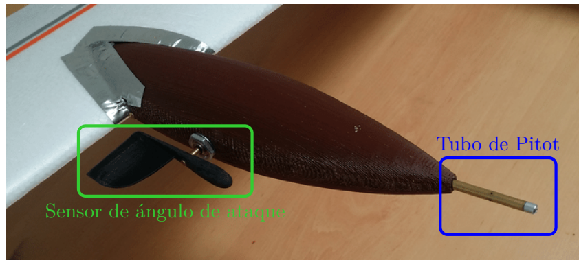
Figura 6.6: Ejemplo de montaje de un sensor de ángulo de ataque y un tubo de Pitot en el borde de ataque de un ala de UAV. Fuente: [63]
