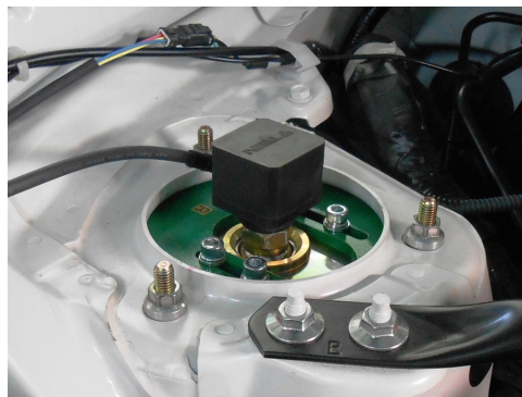
Figura 5.8: Ajuste de la dureza en un amortiguador mediante un motor paso a paso [23].
