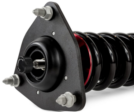
Figura 5.7: Ajuste de la dureza en un amortiguador de manera manual [22].
