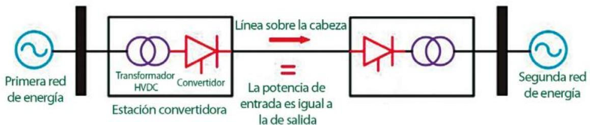
Figura 4: Diagrama de una subestación HVDC (Fuente: Revista Ingeniería Eléctrica).
