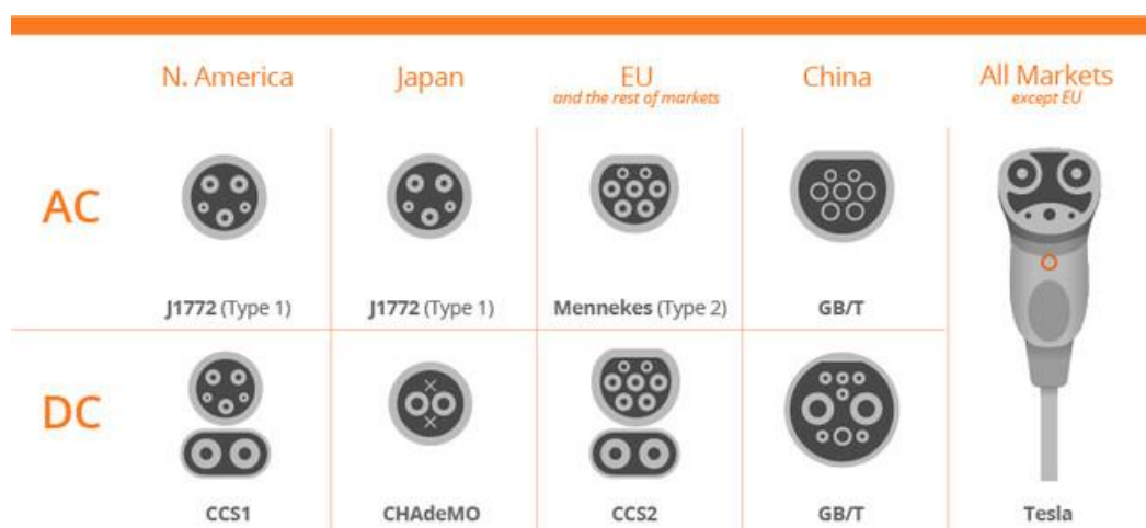
Figura 25. Conexiones en función del lugar y del tipo de carga (Fuente: Xataka [36])
