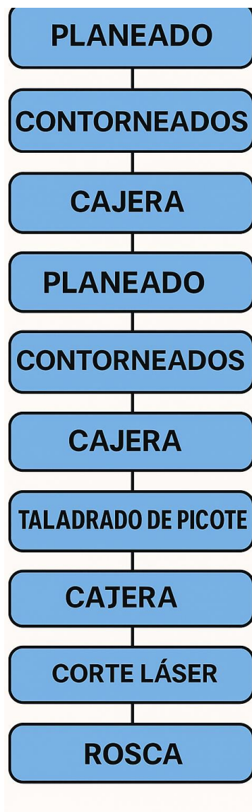
Ilustración 2: Procedimientos a realizar durante el mecanizado.
