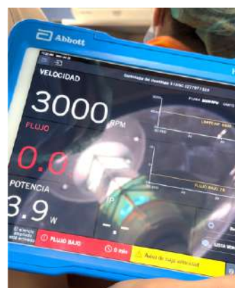
Figura 68. Monitor del sistema HeartMate III®, donde se visualizan los parámetros operativos de la bomba centrífuga de asistencia ventricular izquierda: velocidad de rotación (3000 rpm), potencia (3,9 W) y flujo (0,0 L/min). Imagen propia HUMV.
