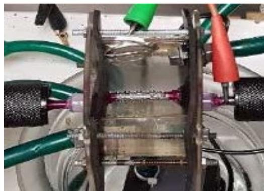
Figura 2. Ensayos convencionales según ASTM F-1624.
