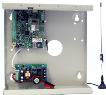
Figura 26. Central de alarmas.
