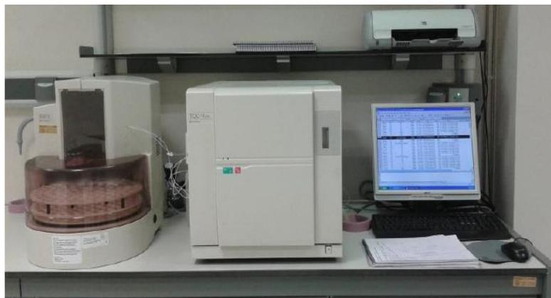
Figura 2.9. Equipo de COT utilizado en la medida.
