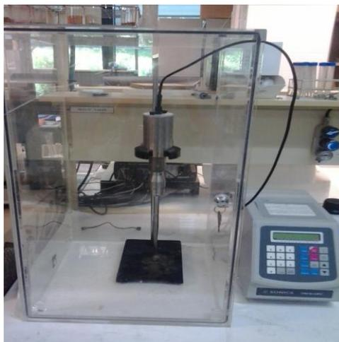
Figura 2.6. Equipo de ultrasonidos Sonic vibracell VCX750.
