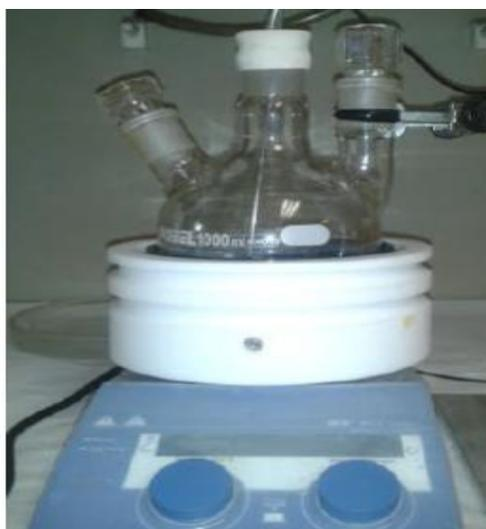
Figura 2.4. Sistema experimental para la síntesis del sólido  $\text{SiO}_2@Fe_3O_4B$ .
