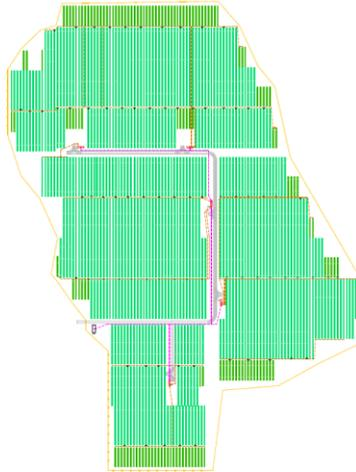
Ilustración 24. Trazado de zanjas baja y media tensión
