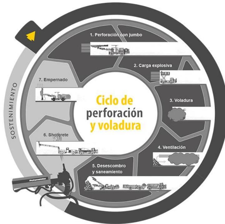
ILUSTRACIÓN 54. PERFORACIÓN Y VOLADURA EN MINERÍA SUBTERRÁNEA. (FUENTE: BEST SUPPORT UNDERGROUND, 2023)
