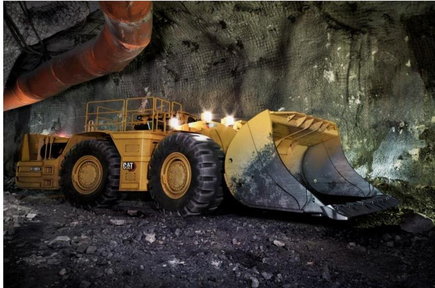
ILUSTRACIÓN 25. CARGADORAS AUTÓNOMAS DE MINERÍA SUBTERRÁNEA LHD. (FUENTE: CATERPILLAR, 2023)
