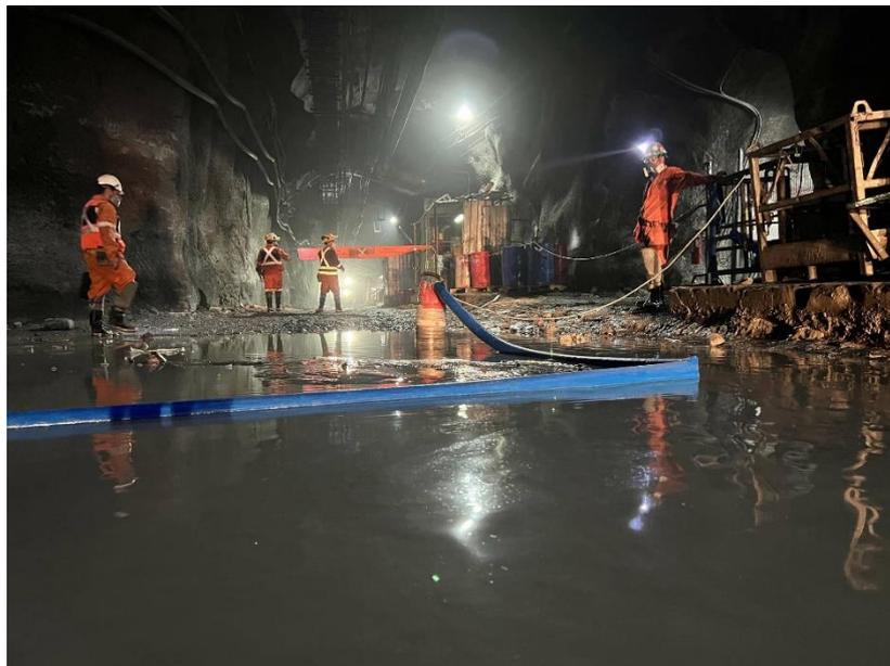
ILUSTRACIÓN 69. DRENAJE DE LA MINA (FUENTE: HCA MINERÍA, 2023)
