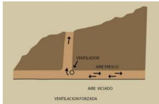
ILUSTRACIÓN 58. DESCRIPCIÓN DE VENTILACIÓN FORZADA. (FUENTE: SERNAGEOMIN, 2018)
