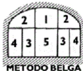
ILUSTRACIÓN 50. MÉTODOS DE EXCAVACIÓN DE TÚNELES. (FUENTE: ACADEMIA.EDU, 2023)
