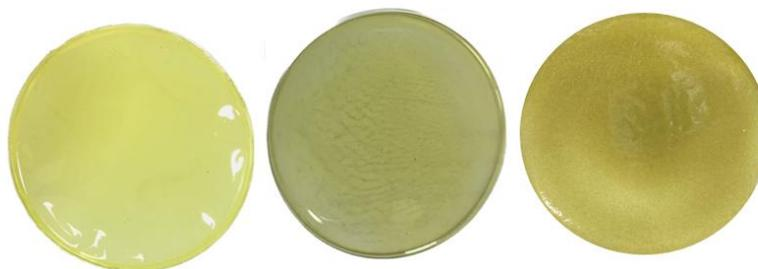
Figura 8. Membranas de Matrimid® (izquierda), Matrimid®/LaNi<sub>5</sub> (medio) y Matrimid®/Mg<sub>2</sub>Ni (derecha).
