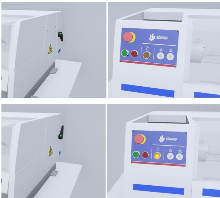
Figura 79. Secuencia de encendido del interruptor
