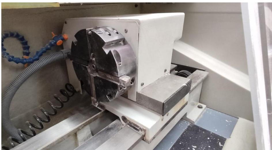
Figura 24. Conjunto del carro portaherramientas
