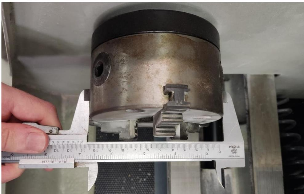
Figura 32. Toma de la medida exterior del eje principal del husillo.
