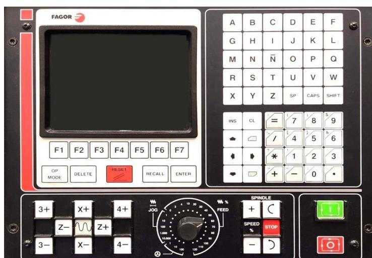
Figura 27. Teclado y pantalla del panel de control.
