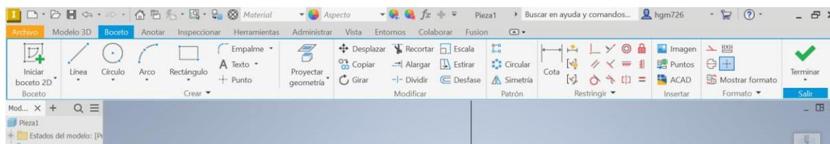
Figura 33. Pestaña 'Boceto' para el dibujo 2D.
