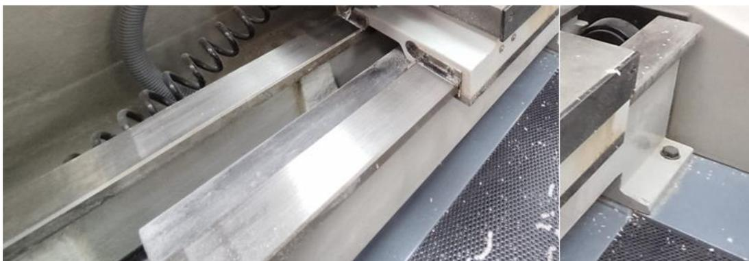
Figura 22. Guías de deslizamiento y anclaje a la bancada
