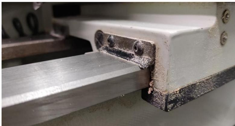
Figura 23. Carro longitudinal sobre las guías
