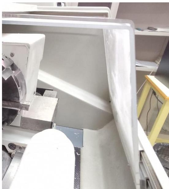
*Figura 21. Solape de la parte móvil bajo la parte fija de la tapa de seguridad*
