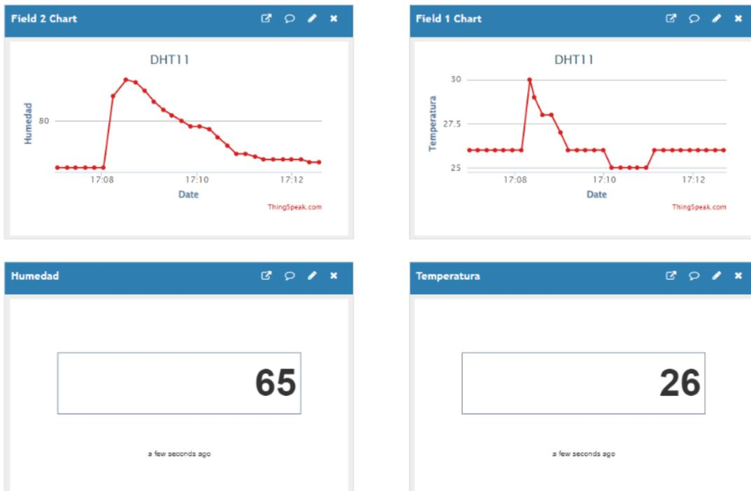
Figura 23. Práctica 11: Humedad y temperatura en tiempo real y en remoto a través de Thingspeak
