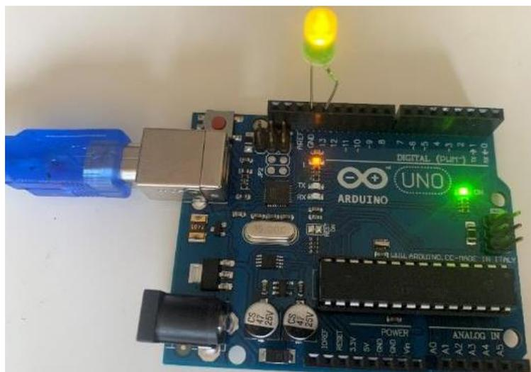
Figura 12. Práctica 1: Encendido de un Led intermitente
