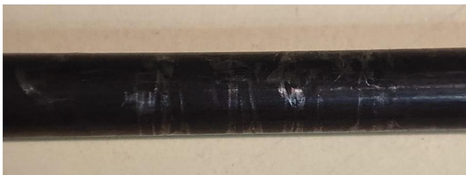
**FIGURA 9. Cable con superficie rayada transversalmente.**
