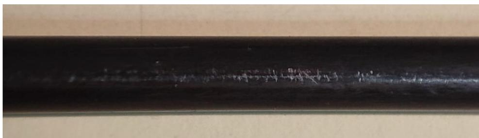
**FIGURA 13. Cable con superficie rayada longitudinalmente.**
