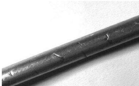
**FIGURA 6. Defecto de grieta transversal.**
