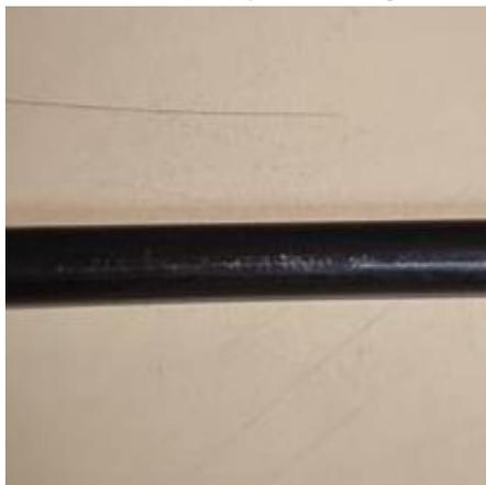
**FIGURA 62. Cable con defecto de rayado longitudinal.**
