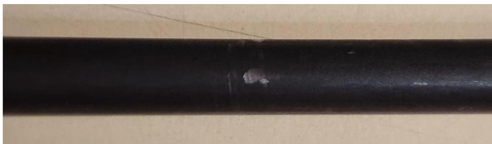
**FIGURA 12. Cable con defecto superficial.**
