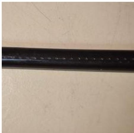
**FIGURA 54.** Imagen con “Picadura” calificada como “Rayado longitudinal”
