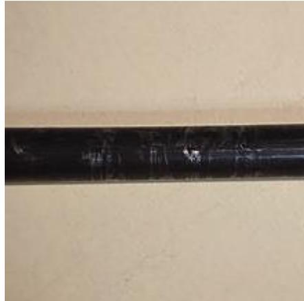
**FIGURA 61. Cable con defecto de rayado transversal.**
