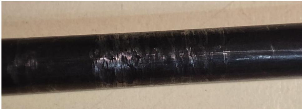
**FIGURA 10. Cable con superficie rayada transversalmente.**
