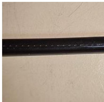
**FIGURA 63. Cable con defecto de picadura.**
