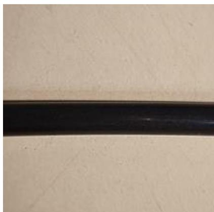
**FIGURA 56. Ejemplo 1 de cable sin defecto.**
