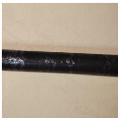
**FIGURA 55.** Imagen con “Rayado transversal” como “Defecto aleatorio”
