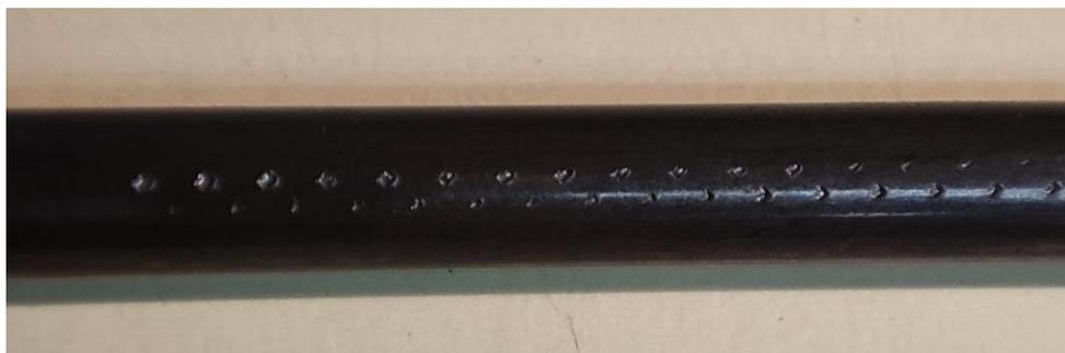
**FIGURA 11. Cable con defecto de picadura.**
