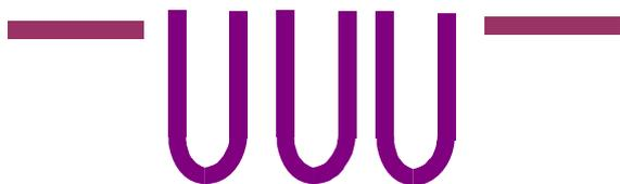
Figura 1: Estructura de un filtro de línea tipo peine a tres resonadores
