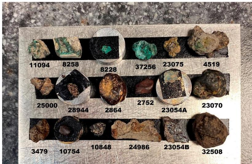
**Imagen 4: Fotografía de algunas de las muestras minerales y metálicas colocadas y preparadas para el análisis por SEM con sus respectivos números de inventario. Se puede observar la plataforma de soporte y como algunas de ellas necesitaron ser alzadas para equiparar su altura a las demás.**
