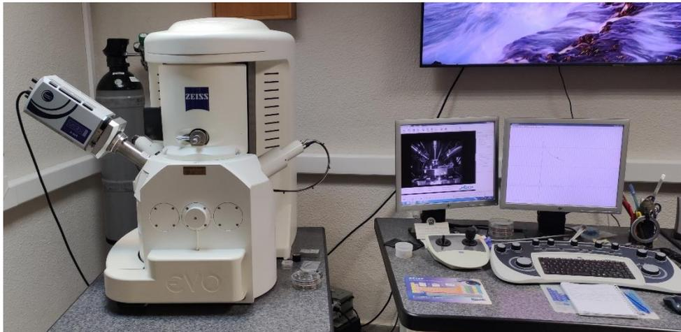
**Imagen 3: Microscopio electrónico de barrido (SEM) utilizado durante este trabajo, marca Zeiss, modelo EVO MA 15. Instalado en el LADICIM y a disposición de la Universidad de Cantabria.**
