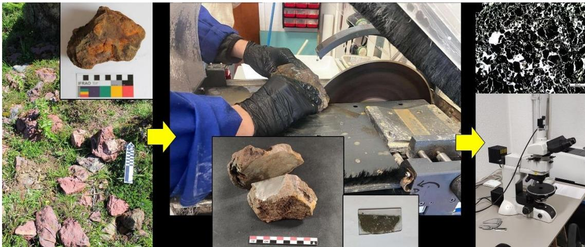
**Imagen 8: Composición de imágenes del proceso de elaboración y análisis de una lámina delgada a partir de la muestra de roca.**
