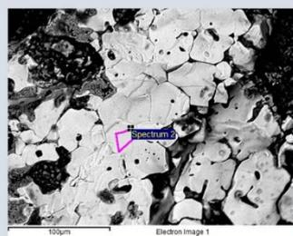
Imagen virtual generada por MEB de la superficie de la muestra, durante el segundo microanálisis, se puede apreciar la microestructura de granos degradados.
