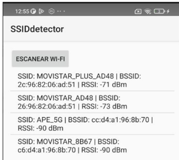
*Ilustración 8: Listado proporcionado por escaneo de la aplicación*
