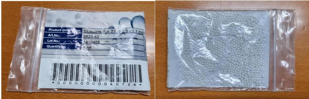
**Figura 3.31** Esferas empleadas como cabeza indentadora.
