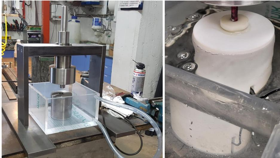
**Figura 3.27** Izqda.: Casquillo inicial de acero inoxidable colocado en su posición dentro de la urna, bajo eje que liberará la carga sobre el punzón. En la imagen no están colocados ni la carga ni el punzón ni las matrices. Dcha.: Casquillo finalmente utilizado de material aislante durante un ensayo.
