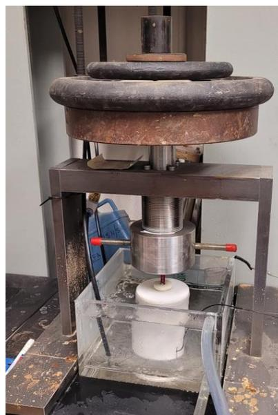
**Figura 3.18** Dispositivo para ensayos SPT con probeta sumergida y en carga constante de  $H_2$  con carga constante desarrollado en esta Tesis durante un ensayo.
