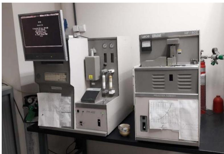
**Figura 3.13** Equipo empleado para las mediciones de contenido de hidrógeno.
