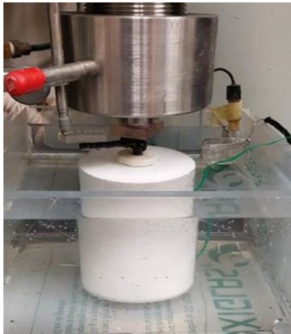
**Figura 3.32** Imagen del casquillo con el punzón y el resto del utillaje de alineación de carga en su interior. Señalizado en rojo se aprecia la protuberancia solidaria al punzón donde registrará el reloj comparador para monitorizar el descenso del punzón.
