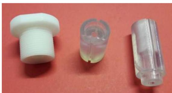
**Figura 3.30** Tornillo de apriete de teflón y matrices de acrilonitrilo butadieno estireno (ABS) por impresión 3D. [15]
