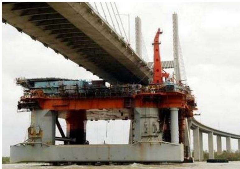
**Figura 1.1** Plataforma petrolera que sufrió una rotura de las líneas de anclaje como consecuencia del huracán Katrina y se incrustó bajo el puente de Cochrane en Mobile, Alabama (fotografía Agencia France Press) [5].
