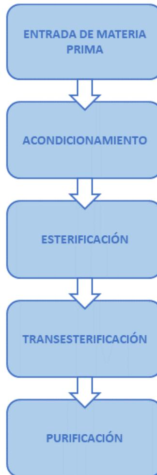
FIGURA 7 ESQUEMA ETAPAS DEL PROCESO PARA LA OBTENCIÓN DEL BIODIESEL
