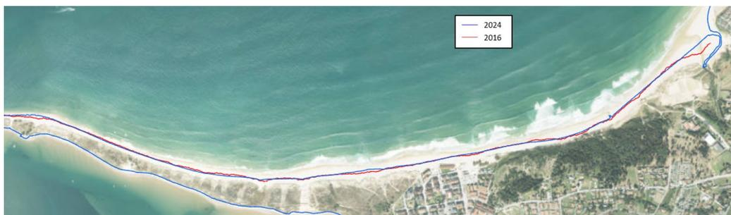
Figura 51. Comparación de la curva de nivel de 5.3 m de las topo-batimetrías de 2016 y 2024.
