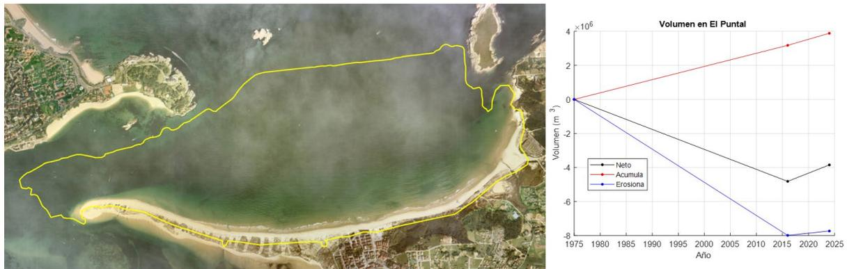
Figura 47. Comparación de volumen de sedimento de 2016 y 2024 respecto a 1975 en El Puntal.
