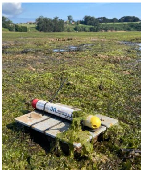
Figura 9: Sensor de presión colocado en el páramo intermareal.
