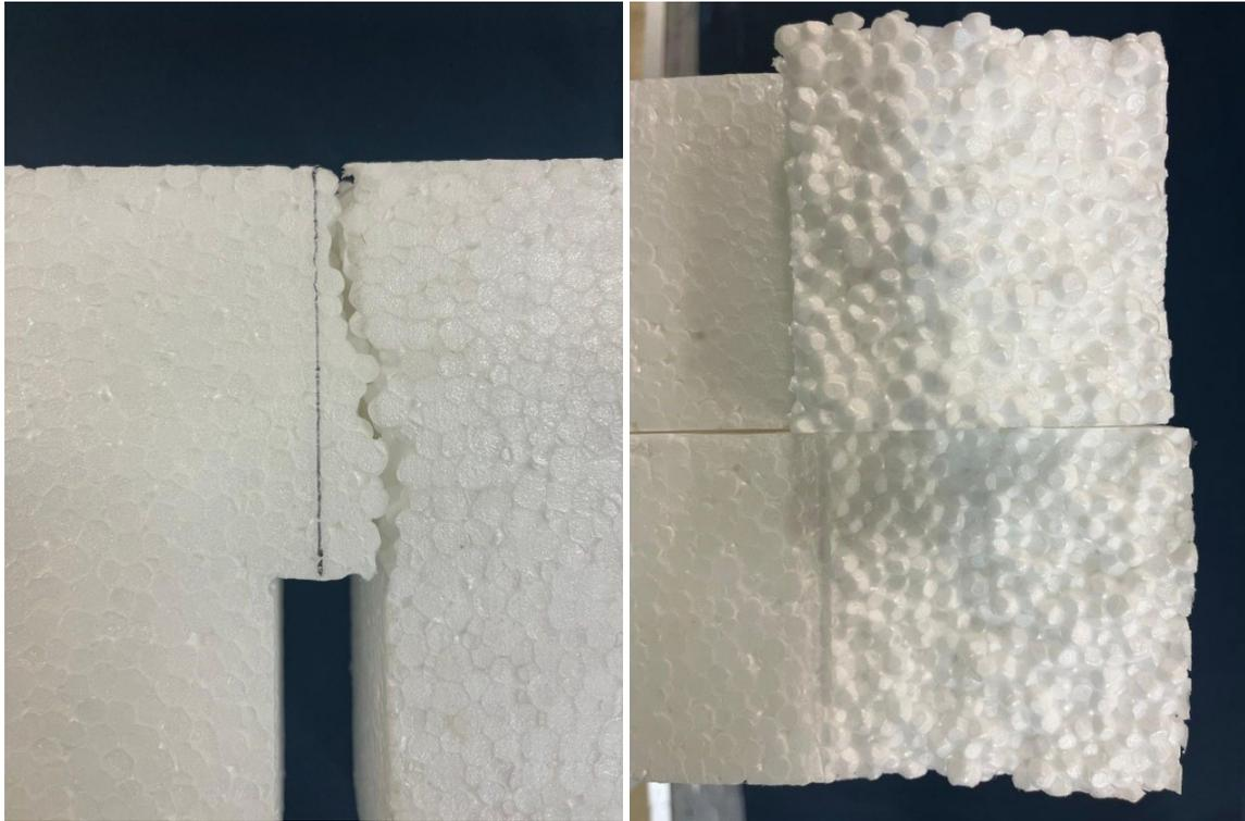
*Figura 43. Sección lateral y transversal de una probeta ligera con entalla H (L-16-H-6).*
