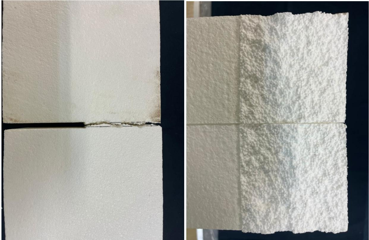
Figura 46. Sección lateral y transversal de una probeta densa con entalla U de 2 mm (D-2-U-6).
