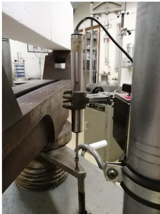
Figura 21. LVDT 25 mm empleado para medir el desplazamiento en los ensayos.
