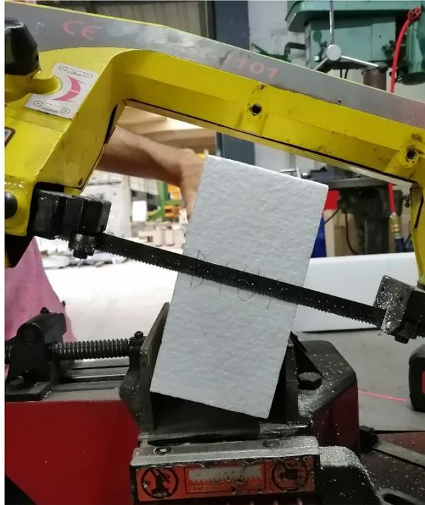
Figura 15. Prueba de corte mecánico con sierra en una probeta lisa (D-1-U-1).
