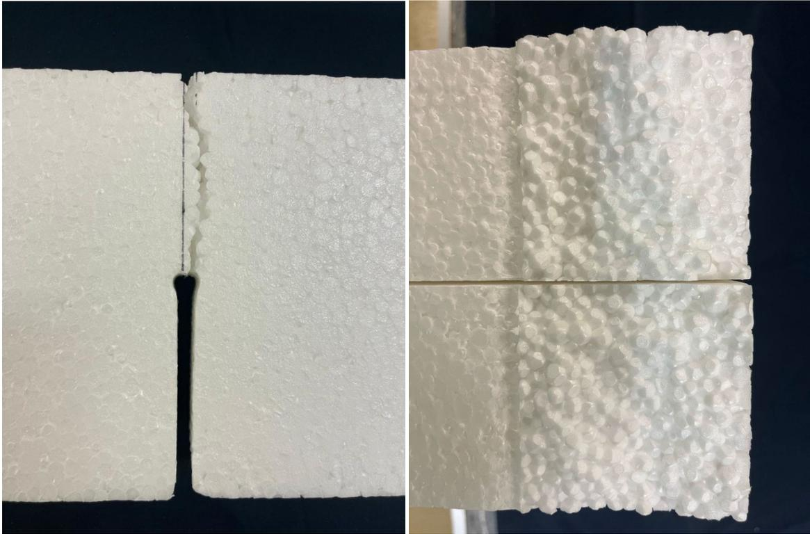
Figura 45. Sección lateral y transversal de una probeta ligera con entalla U de 2 mm (L-2-U-5).
