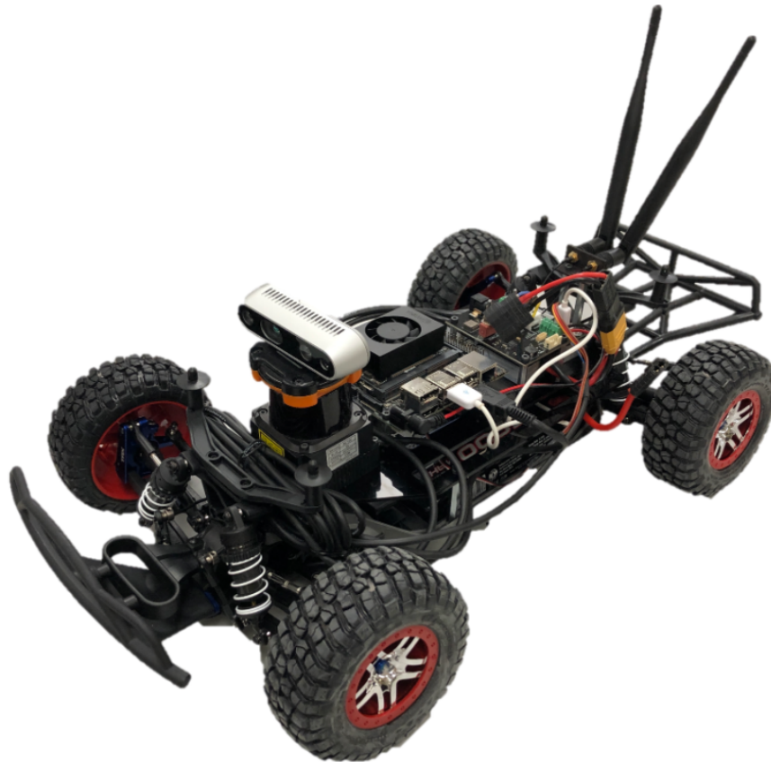
Figura 2.3: Imagen del prototipo F1Tenth utilizado en el proyecto [1].
