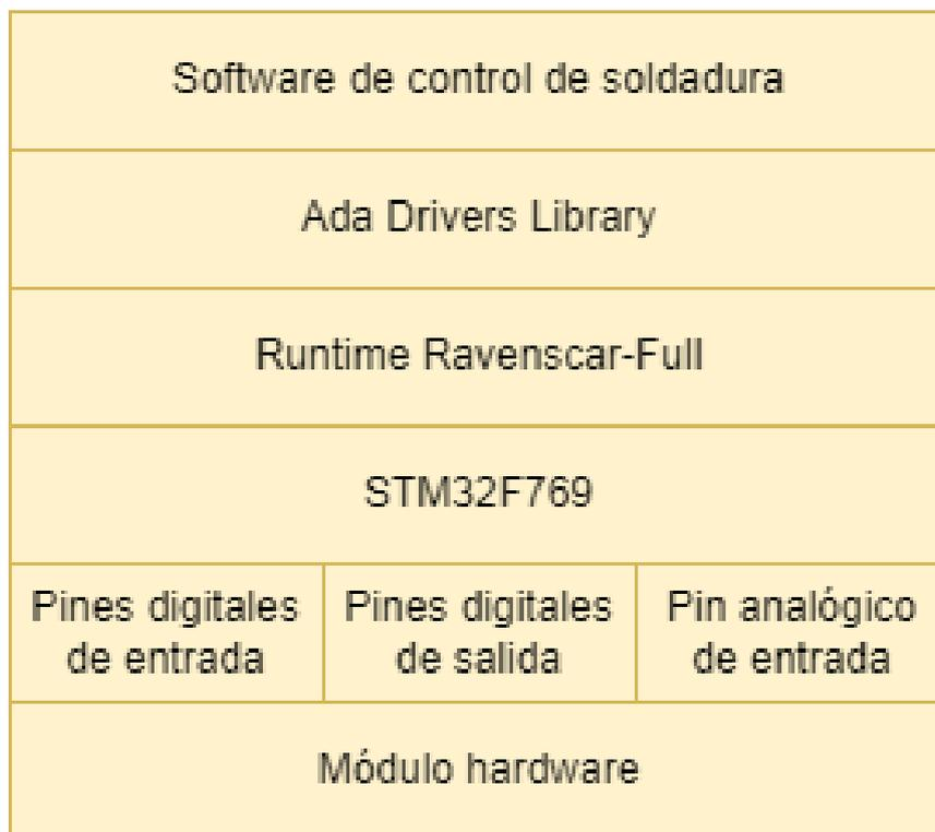
ILUSTRACIÓN 10 DIAGRAMA DE CAPAS DE LA CAPA DE PERCEPCIÓN
