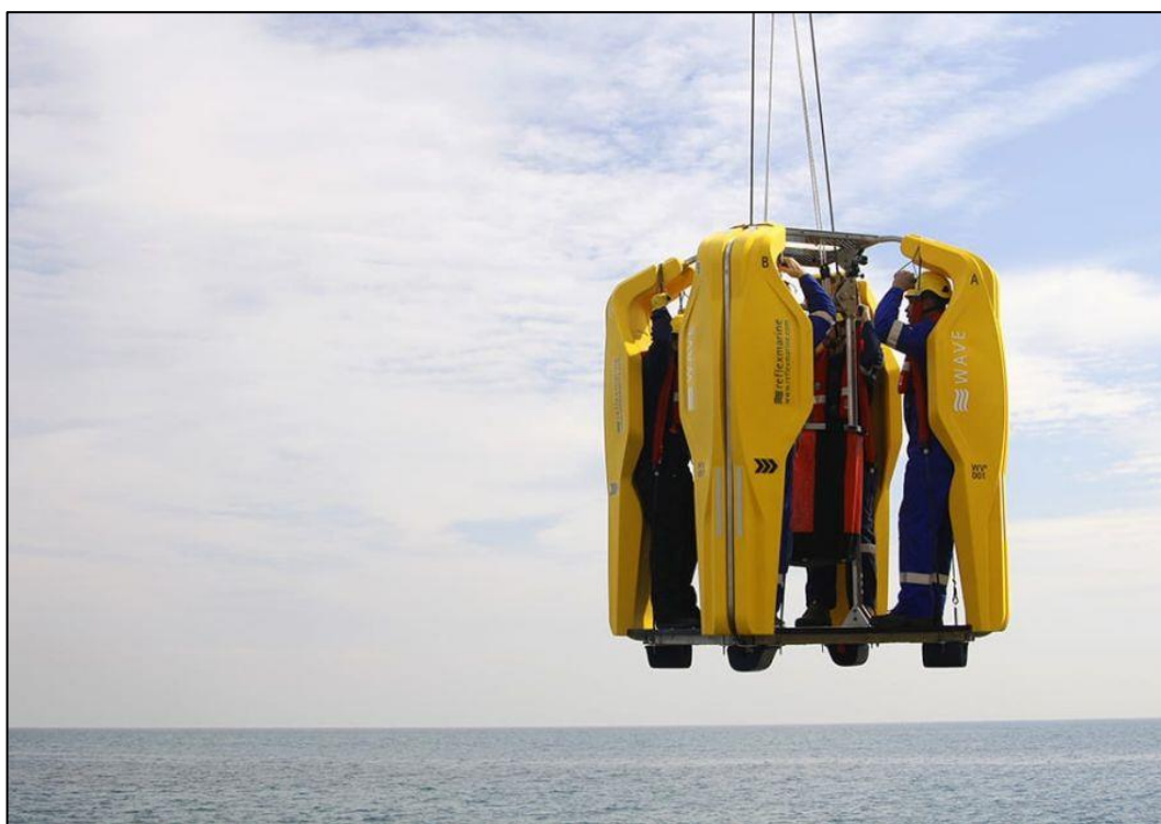
Ilustración 6 - Dispositivo WAVE 4 para la transferencia de personal entre buques. Fuente: Reflex
