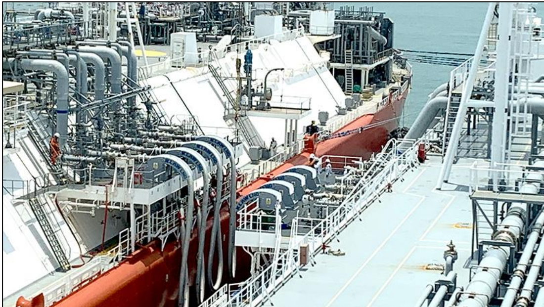
Ilustración 5 - Operación STS entre el FSRU Summit y un buque GNL. Fuente: Summit Power
