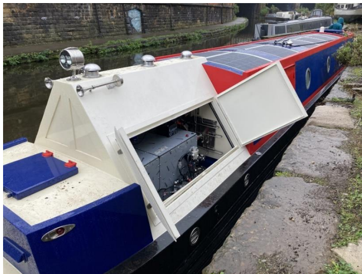
Figura 9. Barco con pilas de combustible de hidrógeno de la empresa Ballard Power Systems . Fuente [86]
