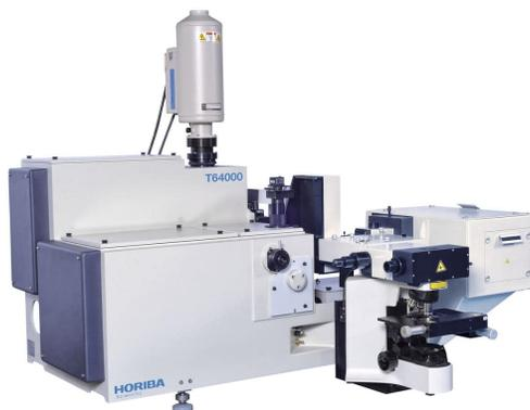
Figura 2.6: Espectrofotómetro Raman T64000 (Horiba Jobin-Yvon).
