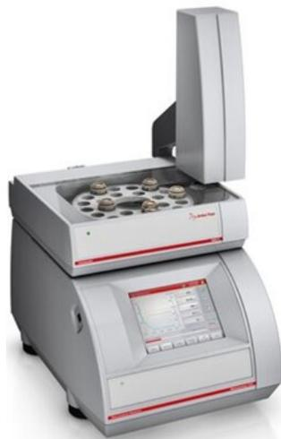
Figura 2.2: Equipo empleado para realizar la síntesis de las nanopartículas asistida por microondas. Dispone de un brazo robotizado que permite la síntesis de hasta 24 muestras previamente programadas de manera autónoma.
