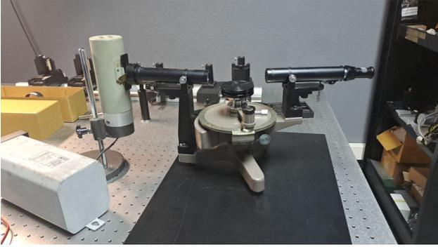
Figura 2.3: Dispositivo experimental. Formado por una lámpara de sodio y un goniómetro. En la plataforma del goniómetro se coloca el prisma.
