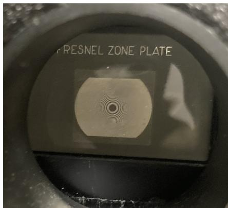
Figura 6.1: Ejemplo de placa zonal de Fresnel usada en el laboratorio.
