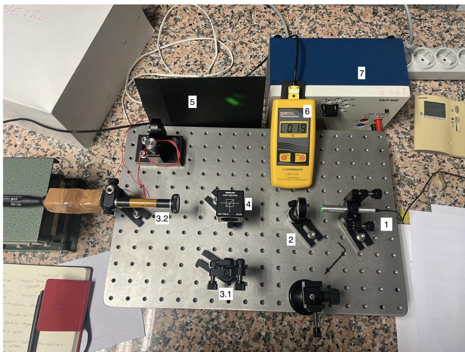
Figura 4.2: Foto del Interferómetro de Michelson utilizado en este experimento.
