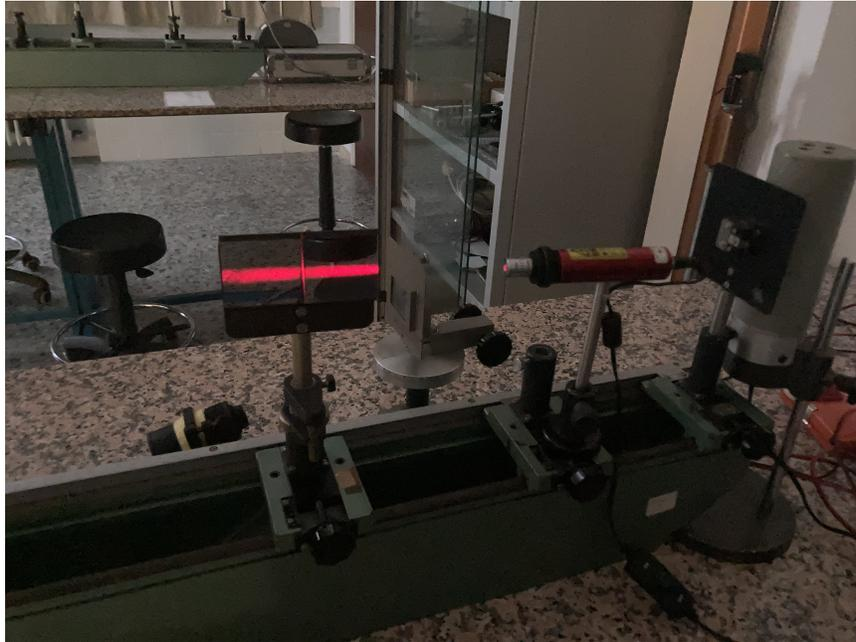
Figura 2.2: Montaje experimental de la propuesta del experimento con el doble espejo de Fresnel.
