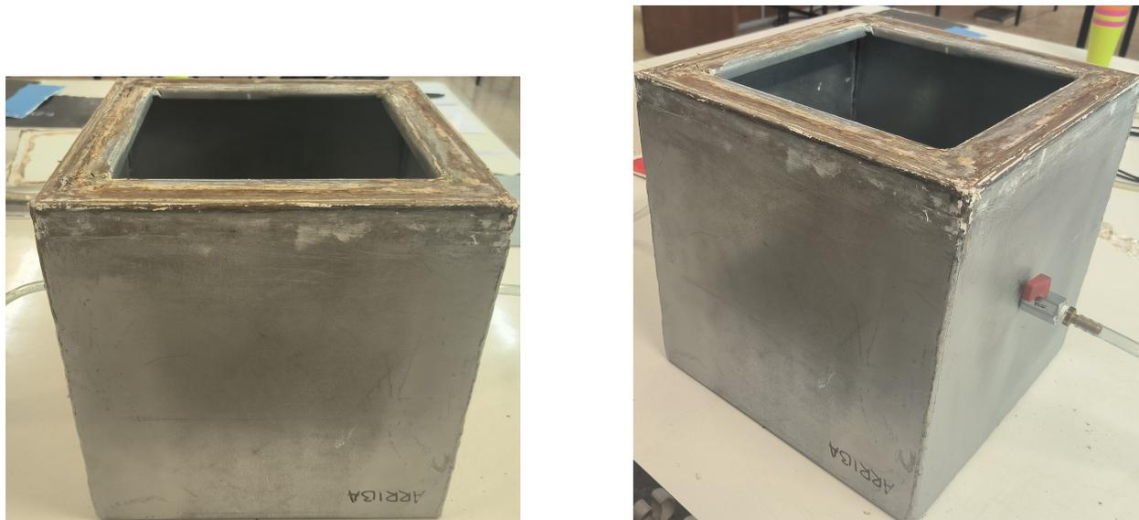
Figura 5.6: Cámara de aluminio en la que se introduce el radón. En la segunda imagen se puede ver el detector radon scout situado en el interior.
