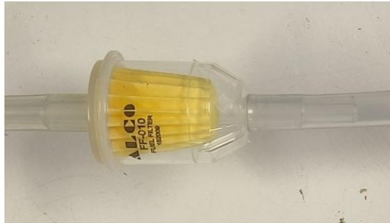
Figura 5.3: Filtro que limita el paso de materiales sólidos como el radio presente en la fuente de radón, permitiendo el paso del mismo, que se encuentra en estado gaseoso, hasta la cámara.
