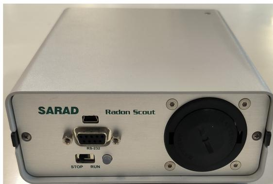
Figura 5.5: Detector radon scout para medir la concentración de radón en el interior de la cámara.
