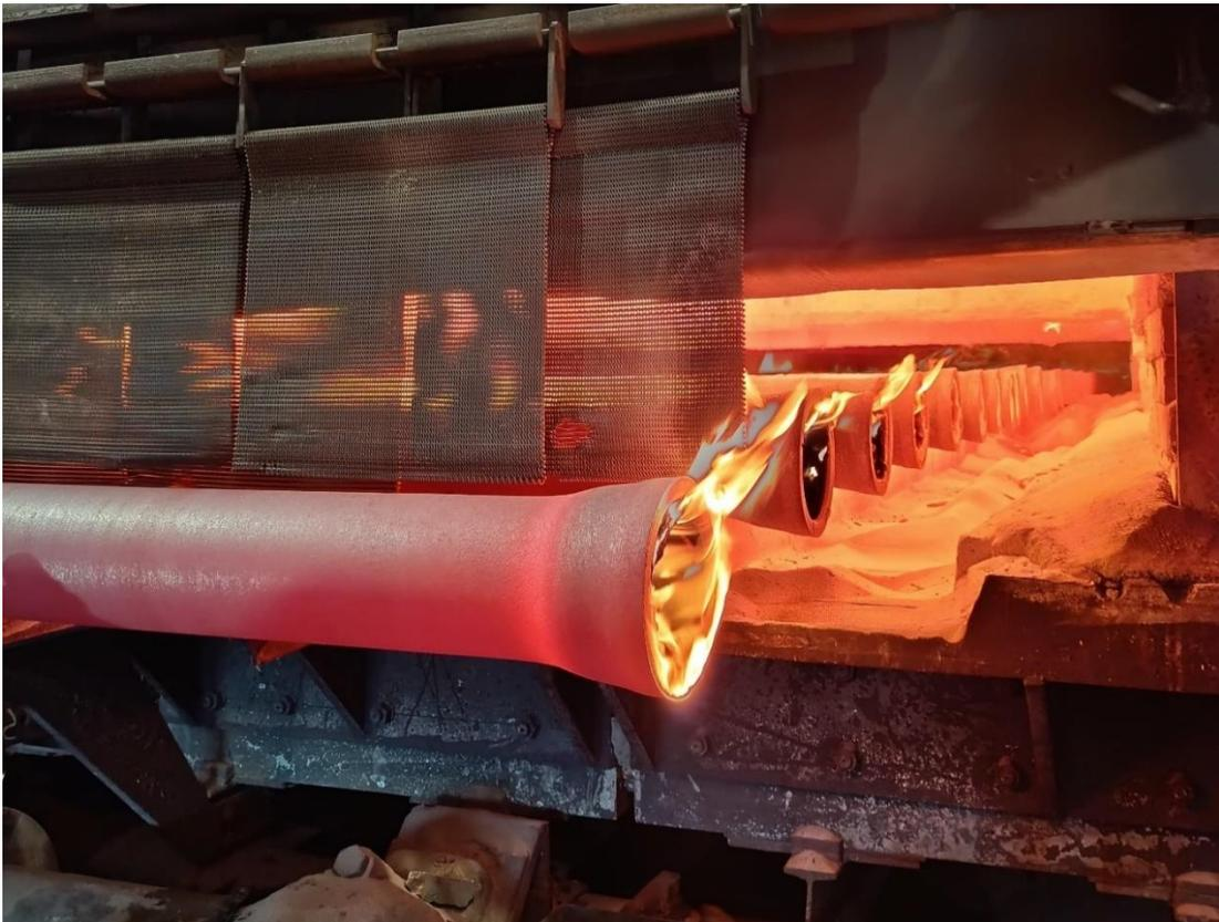
Ilustración 11: Horno de tratamiento térmico
