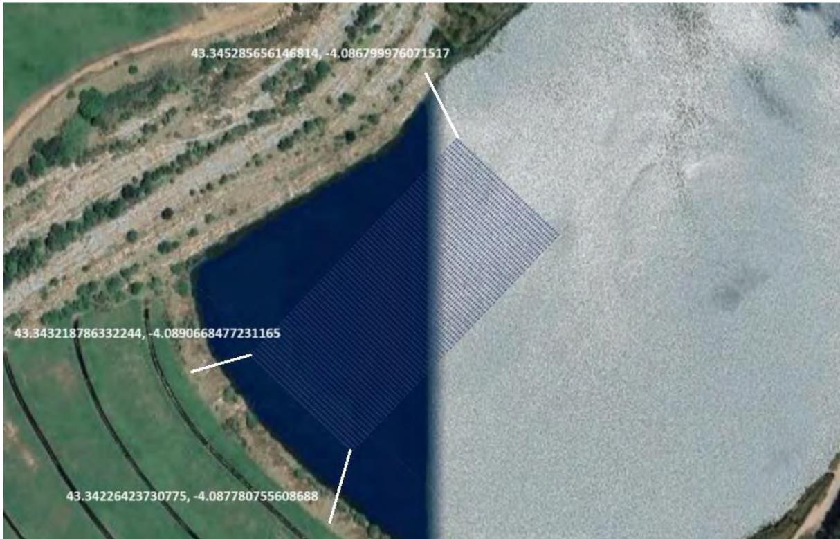
*Figura 20 - Esquema de amarres y coordenadas exactas de estos [Elaboración propia]*
