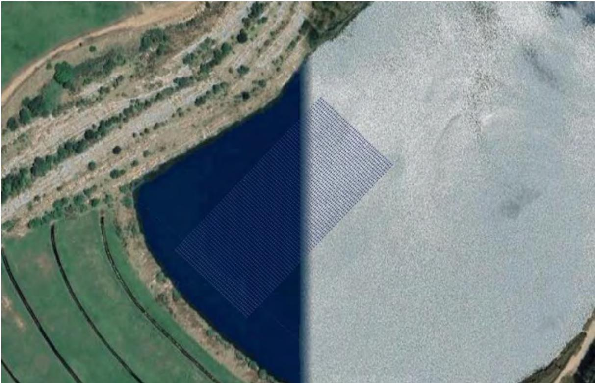
Figura 15 - Posición de la instalación solar en el lago de Reocín. [Elaboración propia SolarEdge Designer]
