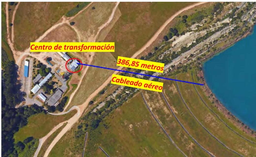
Figura 22 - Centro de transformación y distancia de cableado aéreo. Elaboración propia, Google Maps (2024)
