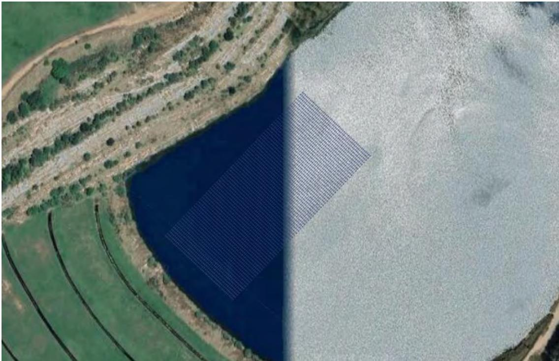
Figura 10 - Diseño de la instalación creado en SolarEdge Designer [Elaboración propia]
