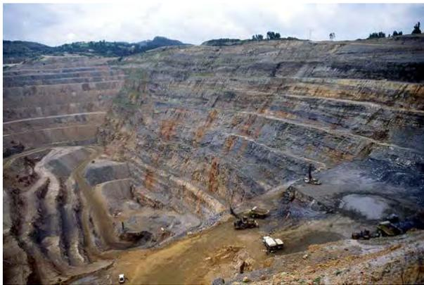
*Figura 18 - Mina de Reocín, excavación en bancos*
