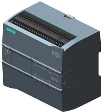
SIMATIC S7-1200, CPU 1214C, CPU compacta AC/DC/relé, E/S INTEGRADAS: 14 DI 24 V DC; 10 DO, relé 2 A; 2 AI 0-10V DC, alimentación: AC 85-264 V AC con 47-63 Hz, Memoria de programas/datos 100 KB
