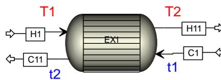
Figura 4. Diagrama de intercambiador de contracorriente de carcasa y tubo
