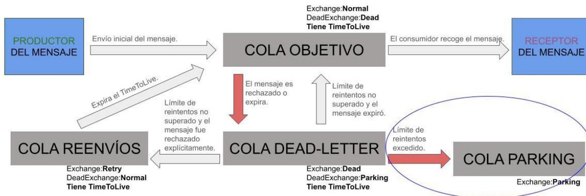
Figura 11: Esquema del envío con cola de parking
