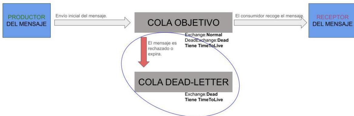
Figura 8: Esquema del envío de mensajes con cola Dead-Lettering
