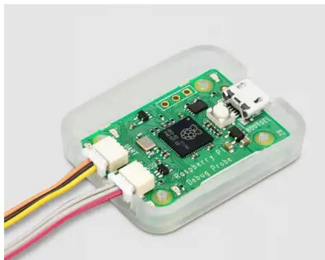
FIG. 9 – SONDA DE DEPURACIÓN DE RASPBERRY PI
