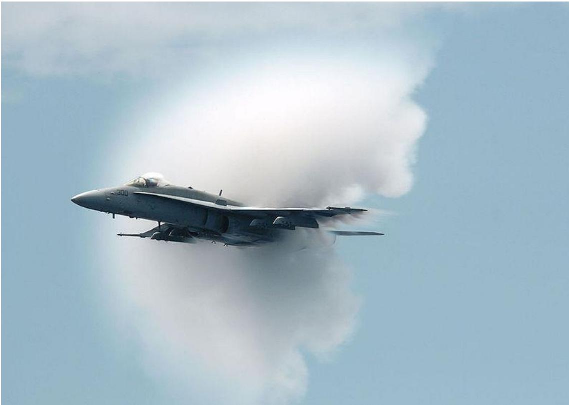
*Figura 7. Ondas de choque en un avión de combate. (Wikipedia)*
