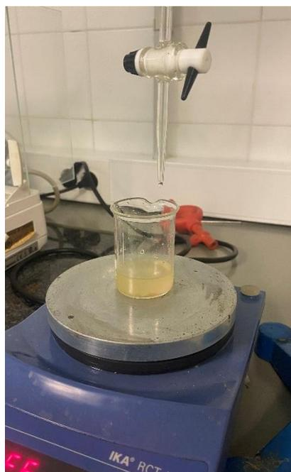
Ilustración 41. Mezcla de disolventes y fenolftaleína preparada debajo de la bureta
