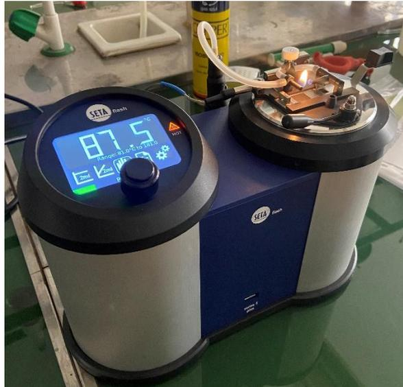
Ilustración 50. Determinación del punto de inflamación
