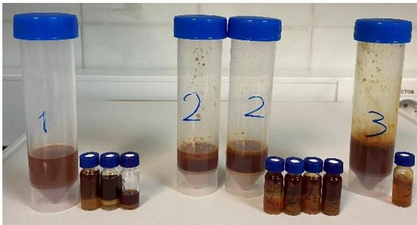
Ilustración 31. Muestras de aceite, en los viales, y de crudo, en los Falcon
