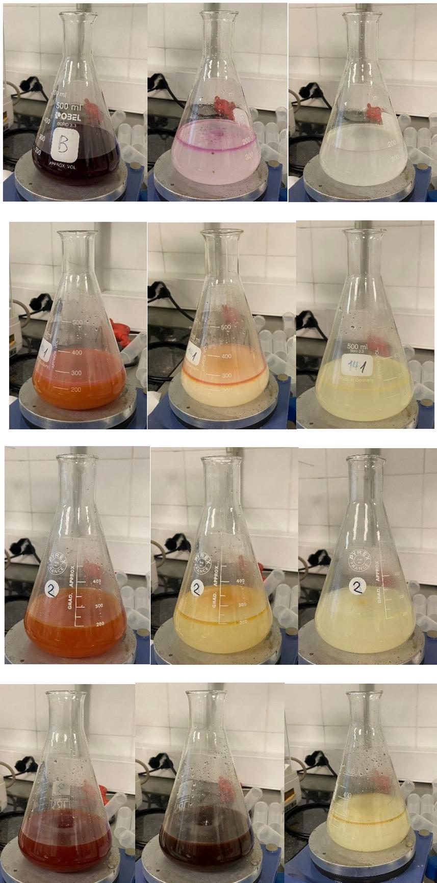
Ilustración 49. Las muestras antes, durante y después de la titulación (de arriba abajo: blanco y muestras 1, 2 y 3)
