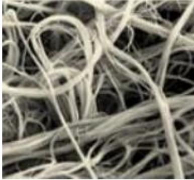
*Imagen 5. Fibras de asbesto serpentinas.*
