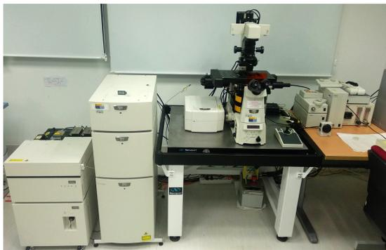
**Figura 3.7.** Microscopio confocal de fluorescencia NIKON A1R.
