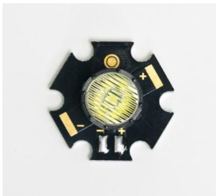
**Figura 3.4.** Led blanco de alta potencia L2-PGC2-S de Bivar Inc. empleados para la mejora de la iluminación del fotoperiodo [34].
