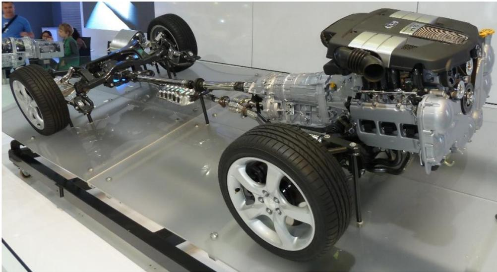
*Figura 1.* Powertrain de un vehículo
