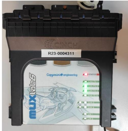
**Figura 5.** Dispositivo MUXlab6.
