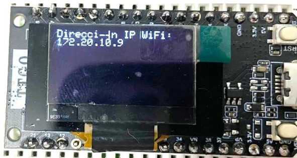
Figura 5.3 Dirección IP de la página Web mostrada en la pantalla OLED del receptor
