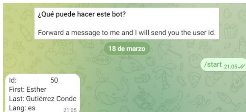
Figura 4.6 Obtención del chat ID de Telegram a través del bot userinfobot
