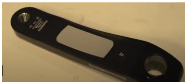
Ilustración 7 Biela preparada para añadir el potenciómetro
