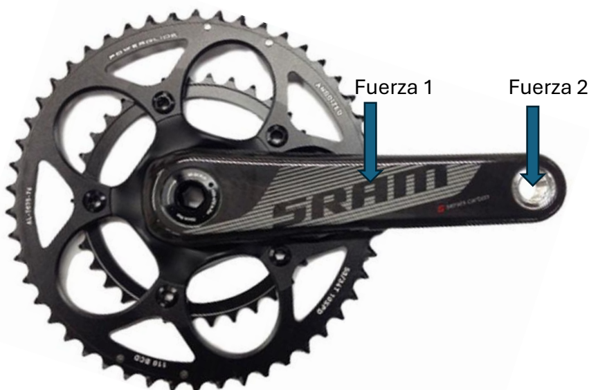
Ilustración 2 Lugar de las fuerzas en la biela durante el pedaleo
