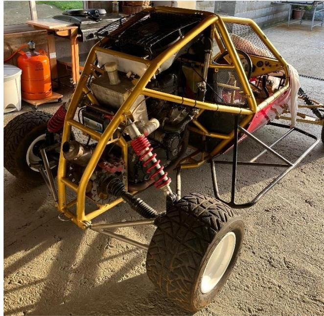
*Ilustración 3: Chasis tubular del carcass*
