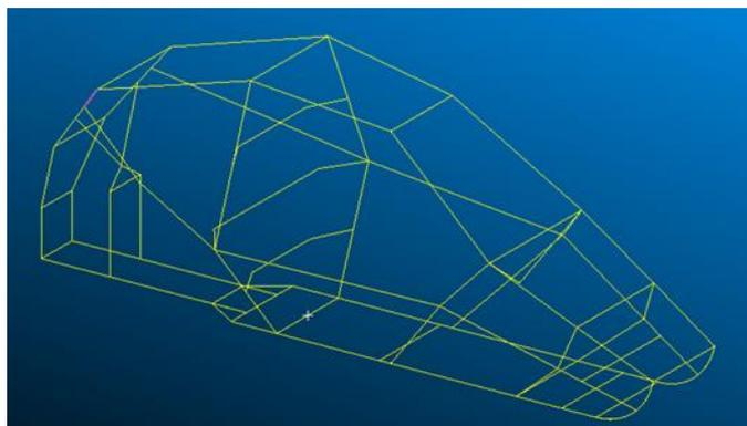
Ilustración 8: Modelo geométrico 1D en MsC Nastran-Patran
