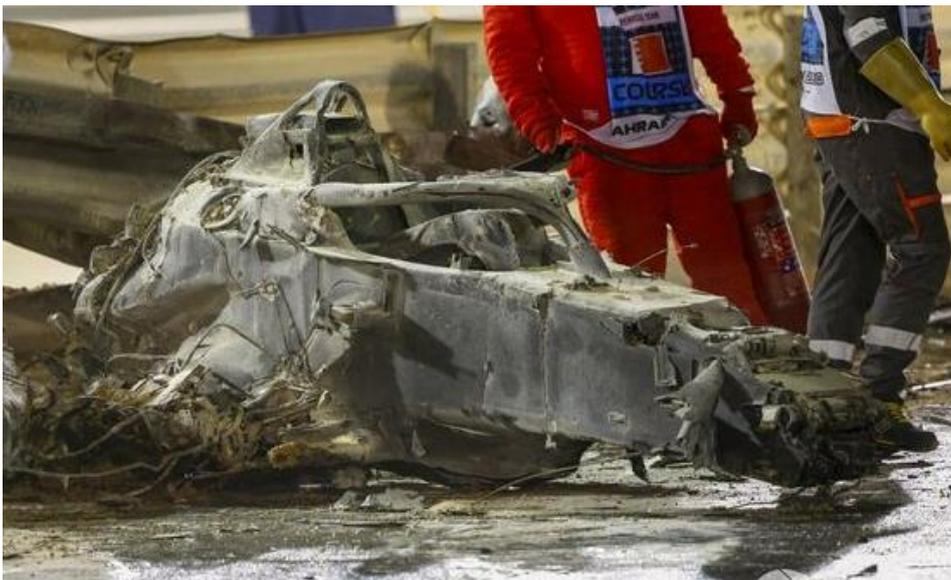
*Ilustración 13: Estado del monoplaza de Grosjean tras el incendio producido en el accidente [9]*
