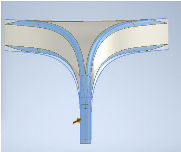
Ilustración 29: Redondeo de las aristas exteriores del pilar central
