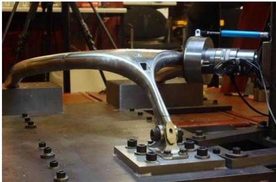
*Ilustración 8: Ejemplo real del test de impacto 2 [13]*
