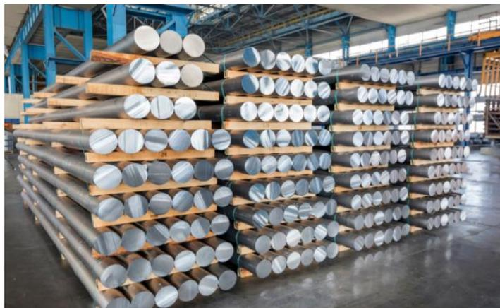
*Ilustración 5: Barras de aleación Ti6Al4V almacenadas por el proveedor Alloys International [15]*
