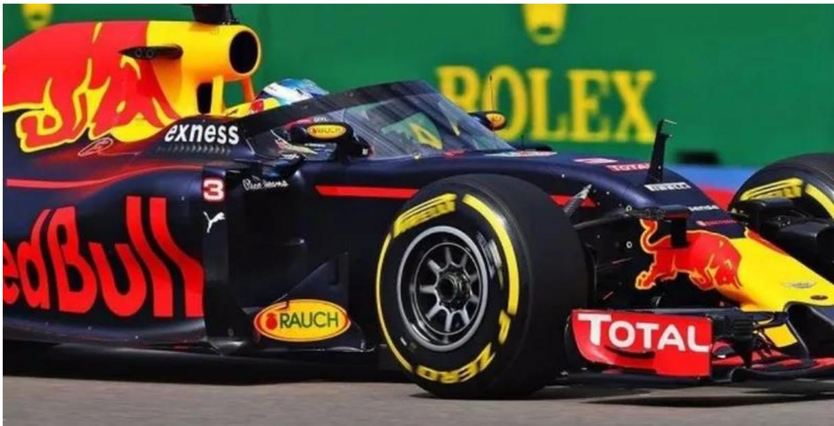
*Ilustración 8: Daniel Ricciardo, piloto de Redbull, probando en unos entrenamientos libres de 2016 el prototipo Aeroscreen [5]*
