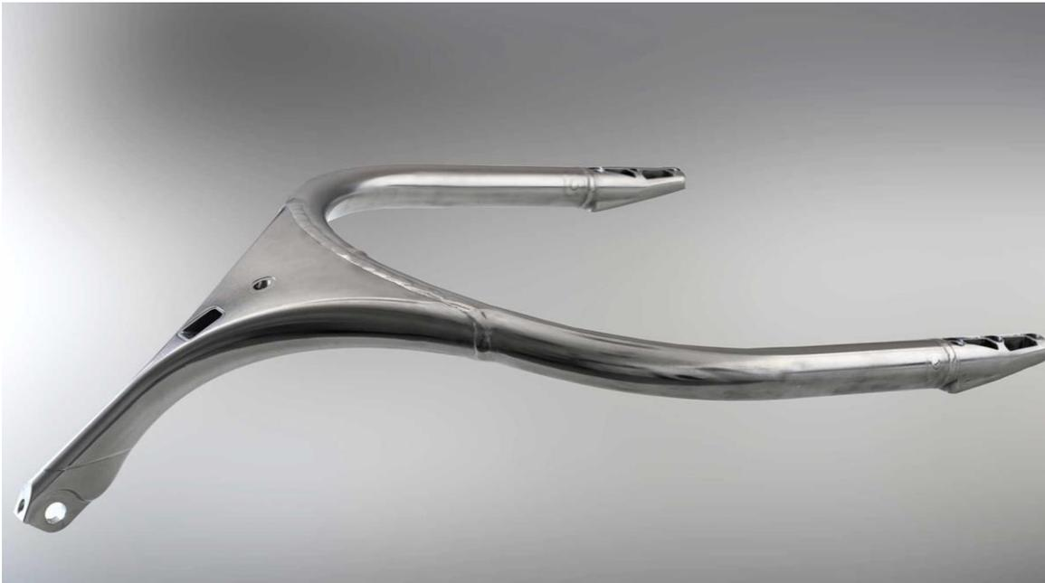
*Ilustración 9: Vista del halo una vez terminado su proceso de fabricación [7]*
