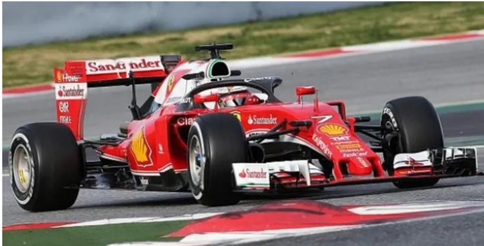
*Ilustración 6: Primera prueba real del halo en pista en el ferrari de Kimi Raikkonen [5]*
