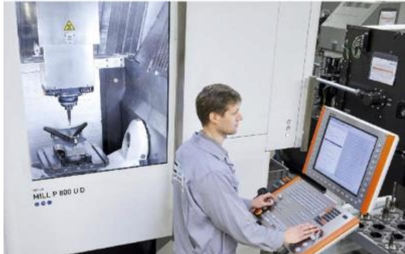
*Ilustración 41: Fresadora de 5 ejes encargada de mecanizar las partes del halo [18]*
