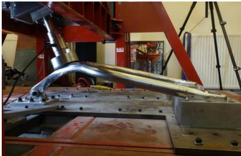
Ilustración 6: Ejemplo real del test de impacto 1 [13]
