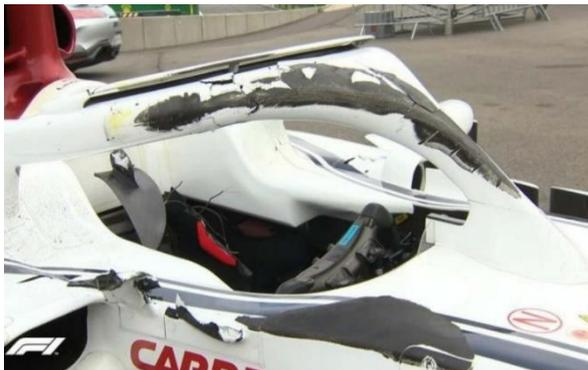
Ilustración 11: Estado del halo de Charles Leclerc después del accidente [8]
