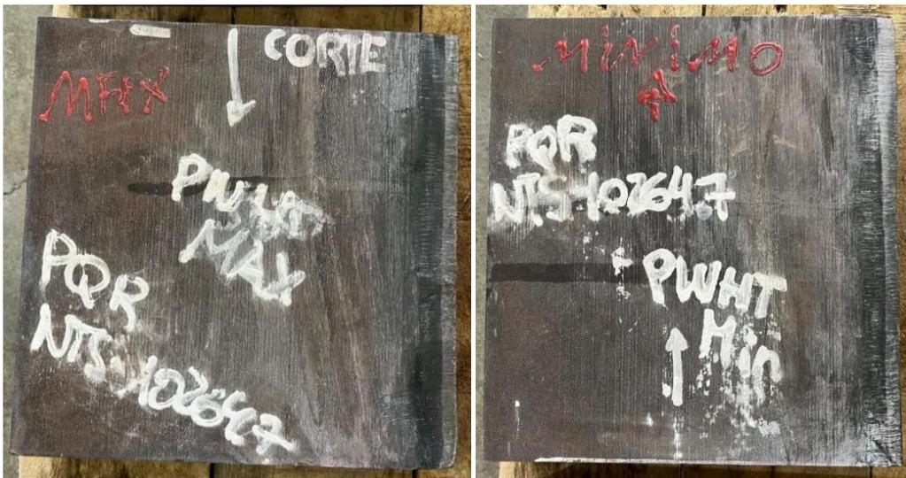
Figura 33. Placas de acero aleado recargadas.
