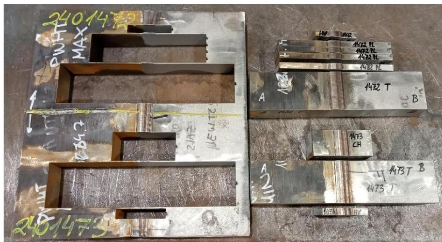
Figura 46. Extracción de las probetas.
