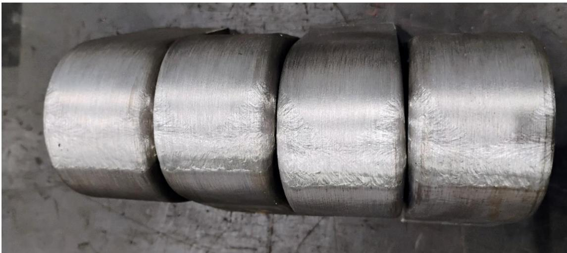
Figura 65. Probetas ensayadas por doblado.
