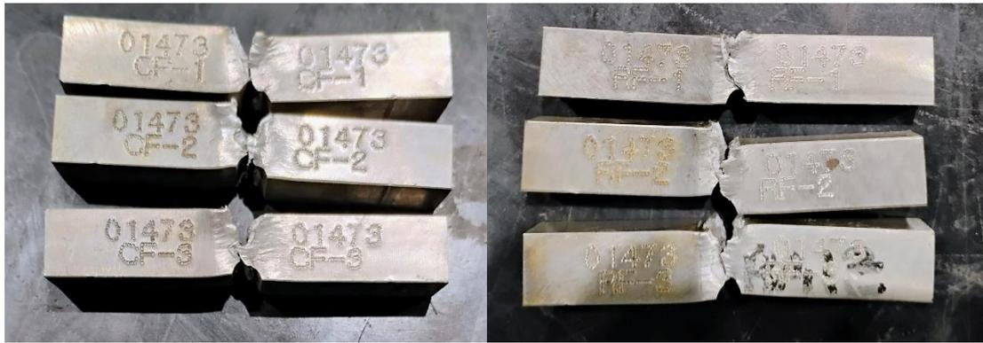
Figura 64. Probetas ensayadas por impacto.
