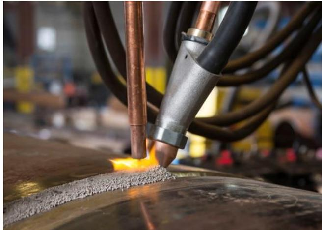
Figura 7. Soldadura SAW [8].
