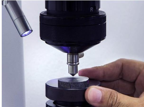
Figura 19. Ensayo de dureza [23].
