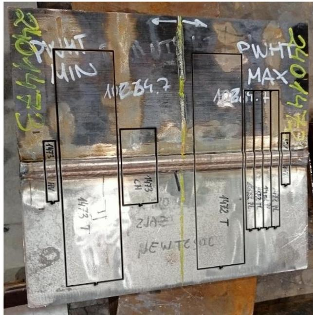
Figura 45. Marcado del cupón para extraer las probetas.
