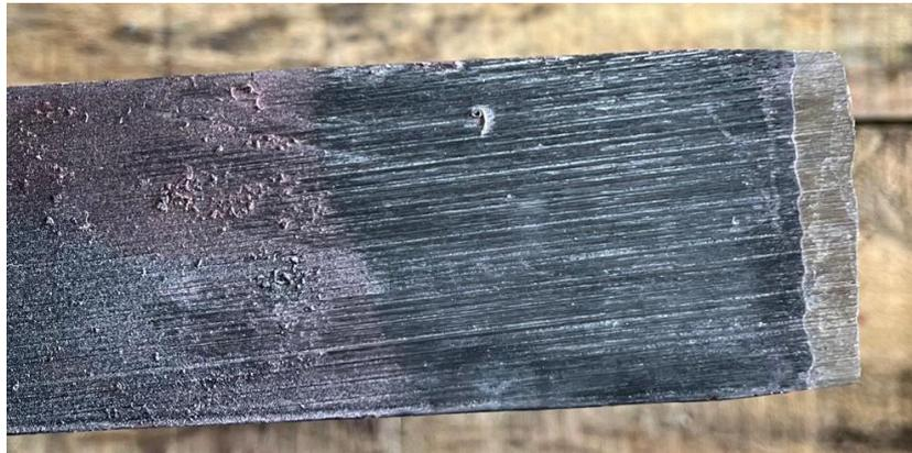
Figura 34. Espesor de la placa recargada.
