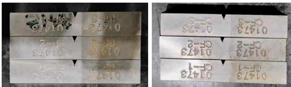
Figura 50. Probetas obtenidas para el ensayo de Charpy del tratamiento térmico de mínima condición, las tres de la izquierda pertenecientes a la soldadura manual y las tres de la derecha a la automática.
