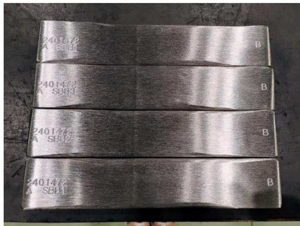
Figura 51. Obtención de 4 probetas con la condición de tratamiento térmico máximo.
