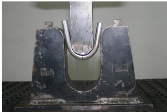
Figura 18. Ensayo de doblado [22].
