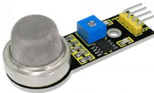
Figura 2.9. Sensor de gas analógico MQ-2 [18]
