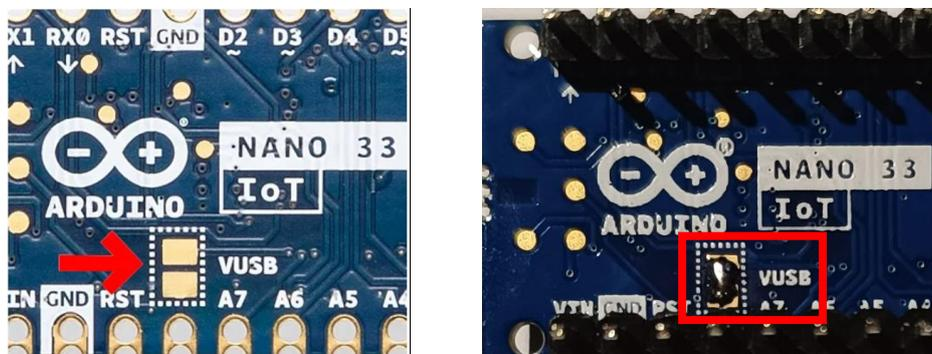
Figura 2.4. Jumper sin soldar (izquierda) y soldado (derecha) del Arduino Nano 33 IoT [9]
