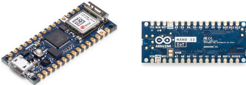
Figura 2.1. Arduino Nano 33 IoT [6]
