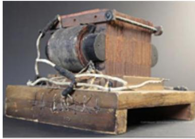
Figura 5. Primer prototipo del transformador de Stanley de 1885, en el Museo de Berkshire, Massachusetts,
