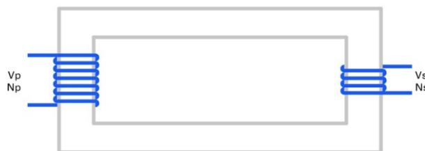
Figura 7. Modelización de un transformador reductor
