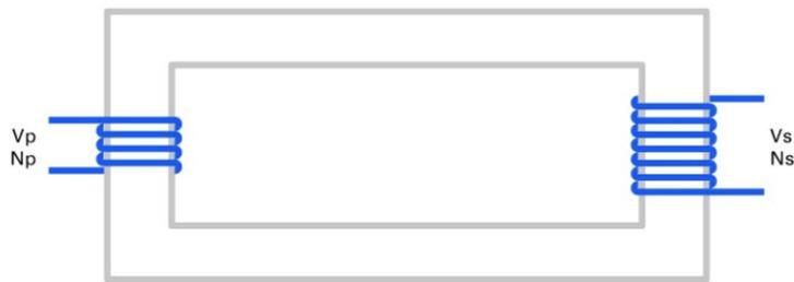
Figura 6. Modelización de un transformador elevador
