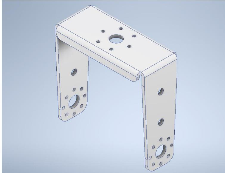
*Ilustración 28: Brazo a antena*
