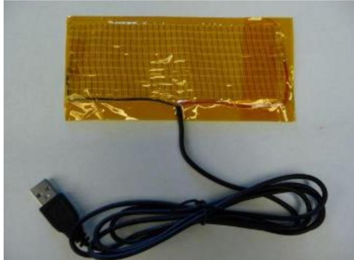
*Ilustración 24: Malla calentadora lista para usar*
